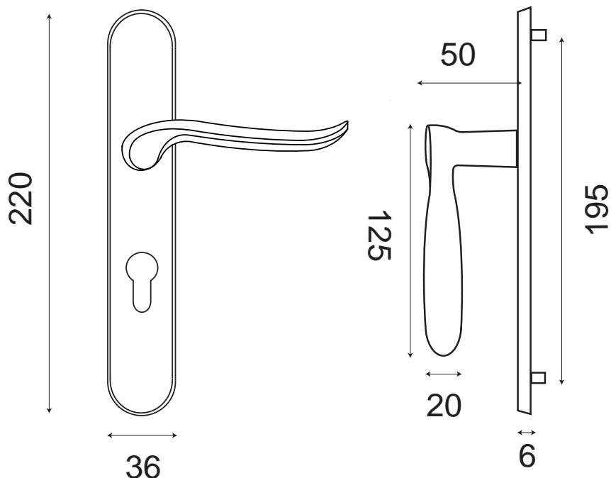
La bâquille massive Orphée à la finition veloutée est montée avec ressort de rappel sur une grande plaque fixation 195 sauf sur plaque cylindre.
