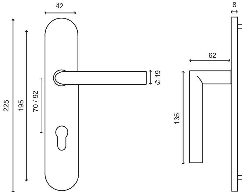
Poignée tubulaire à section ronde montée sans ressort de rappel sur plaque borgne ou cylindre entraxe 70 ou 92 avec piliers pour un meilleur maintien, ou condamnation
