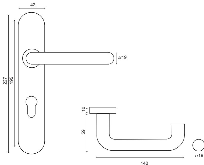
Poignée tubulaire recourbée anti-accrochage sur grande plaque aux extrémités arrondies pour portes de 40 / jusqu'à 50mm en Cylindre
